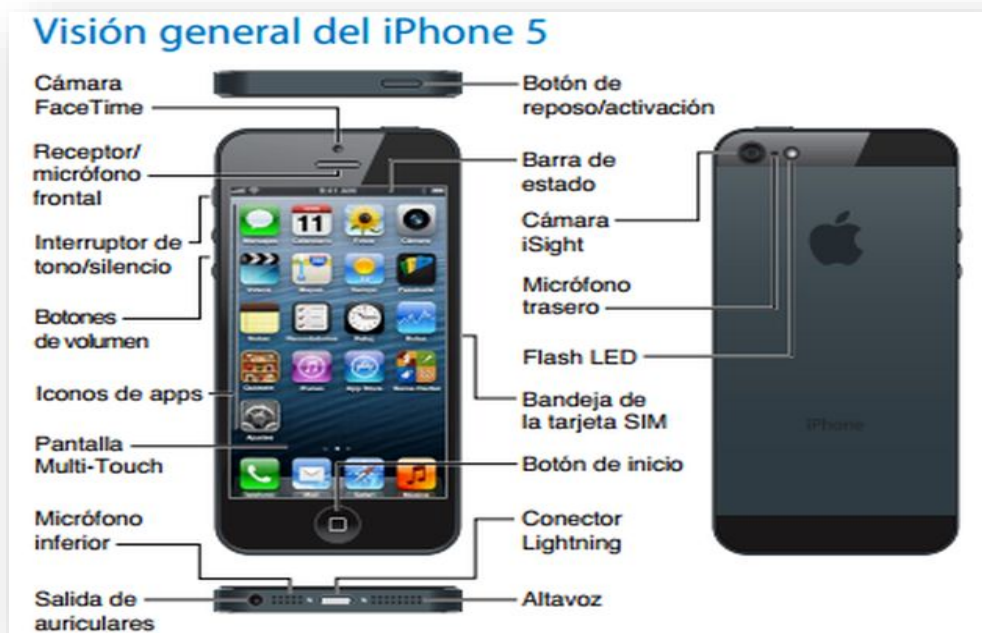
Ilustración 2. Estructura del Smartphone. Fuente: https://www.areatecnologia.com/images/Partes-smartphone.jpg
